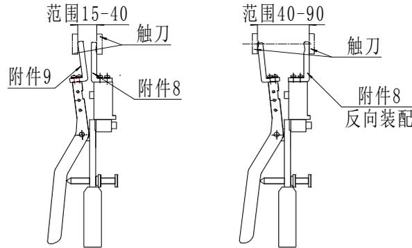
图 11 GN 系列户内隔离开关测量示意图
