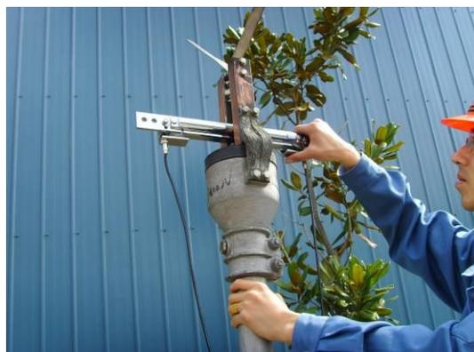
第三步 测量触指压力
