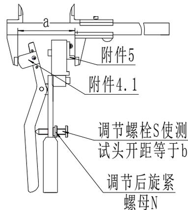
图 4 模拟触头宽度测量示意图
