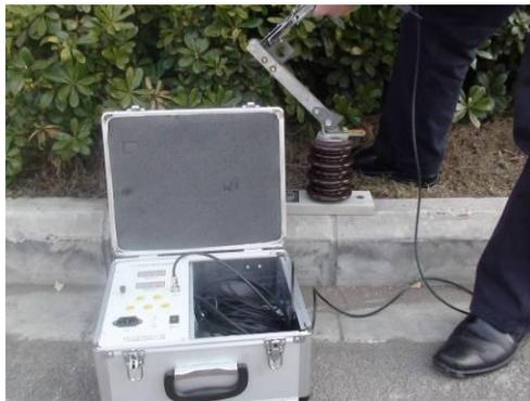
第三步 测量触指压力
