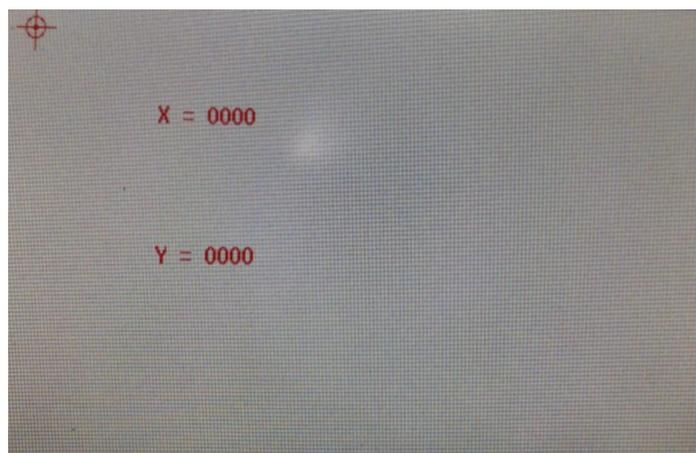
用圆珠笔或者螺丝刀头轻轻点击上图圆心所在位置，停留时间大约为 2 秒中以上，4 个角全部校正完毕后，会提示校准成功，然后回到主界面菜单。如果一次不成功，请再次重复操作。出厂前已校准好。
